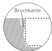
Kleben Sie vor dem Verputzen den eingesetzten Einfassungskasten ab, um Beschädigungen oder Verschmutzungen zu vermeiden.
